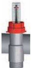
Коллектор с запорно-балансировочными вентилями позволяет точно отрегулировать систему и по метке на ручке вентиля определить его установочное положение. Вентили вращаются на 360° между позициями: 0 — полностью закрытый и 5.5 — полностью открытый. Чтобы осуществить регулировку снимите красный колпачок и поверните белую тарированную ручку до нужного значения.
