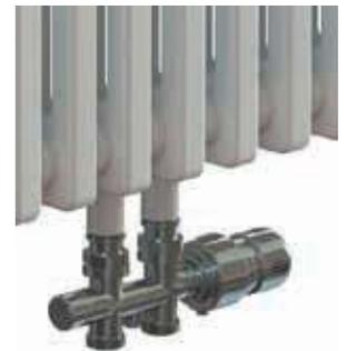
Вентили и узлы дизайн-серии с резьбой M24×19 комплектуются накладной гайкой цвета серебристый металл под трубу диаметром 16 мм, поэтому для подключения пластиковых, металлопластиковых и медных труб достаточно выбрать внутренний адаптер по параметрам используемой трубы (материал, диаметр и толщина трубы).
