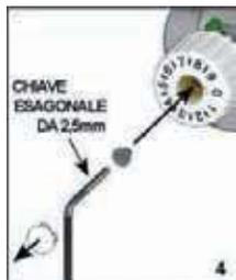
При этом, регулирующая ручка сможет изменять расход рабочей среды от полного закрытия до выбранного положения.
