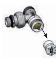
4. Убрать ключ регулировки и установить регулировочную пластиковую ручку или термостатическую головку.
