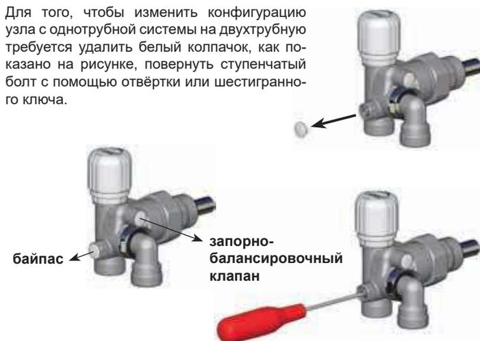
Пример установки узла для одно- и двухтрубной системы с регулируемым межосевым расстоянием.
