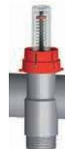
Коллектор с запорно-балансировочными клапанами позволяет точно отрегулировать систему и по метке на ручке вентиля определить его установочное положение. Вентили вращаются на 360° между позициями: 0 – полностью закрытый и 5,5 – полностью открытый. Чтобы осуществить регулировку снимите красный колпачок и поверните белую тарированную ручку до нужного значения.
