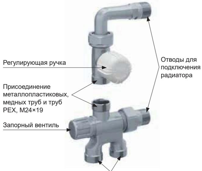
Присоединение металлопластиковых, медных труб и труб PEX, M24×19. Межосевое расстояние: 35 мм
