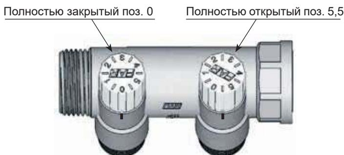
После настройки клапанов можно установить защитный колпачок, который предохранит выставленные настройки. Для этого просто наденьте его на ручку вентиля.
