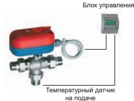
Для поддержания требуемой температуры смешанной воды, блок управления (соединенный с сервоприводом) регулирует положение шарового крана с помощью сигнала датчика температуры, расположенного на выходе крана.
