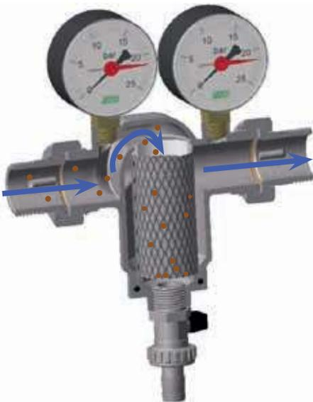
Корпус фильтра FAR для бытовых систем полностью изготовлен из стойкой к dezincованию латуни марки CC752S (CR) – (DZR-латунь), в которой цинк связан легированием и предотвращён от вымывания. Такая латунь гарантирует длительный срок эксплуатации фильтра и более чистую воду, а также стойкость к коррозии, возникающей в застойных областях потока воды, особенно в воде, перенасыщенной кислородом и двуокисью углерода.
