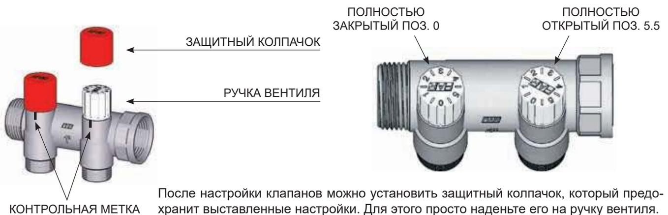
После настройки клапанов можно установить защитный колпачок, который предохранит выставленные настройки. Для этого просто наденьте его на ручку вентиля.
