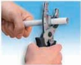
Отрезать трубу перпендикулярно ее оси специальными ножницами
